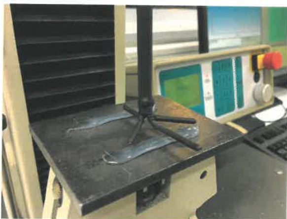
Bild 1: Künstlicher Taubenfuß in der Versuchsanordnung auf der Materialprüfmaschine
