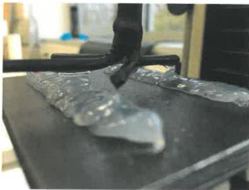
Bild 6: Brückenbildung bei 30 °C warmem Klebestrang
